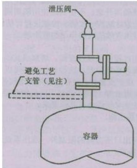
注.在泄压阀入口管道上安装工艺支管相关的警告见 4.7 节。
